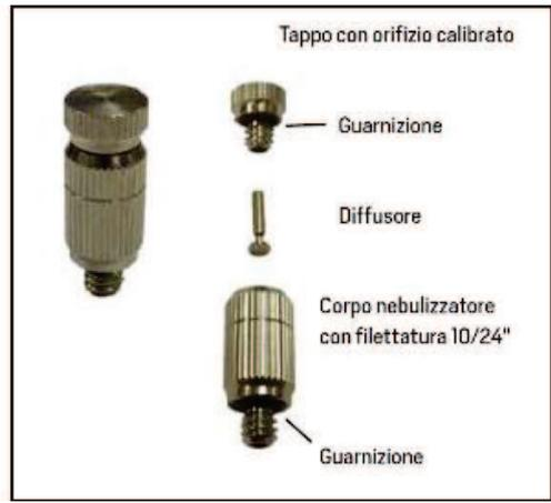
Principio di funzionamento: le gocce d'acqua nebulizzata, si attraggono elettrostaticamente con le particelle presenti nell'aria inglobandola. Per gravità, le minuscole goccioline che hanno catturato le particelle cadono a terra purificando l'aria stessa, riducendo altresì le cariche elettrostatiche presenti. Dovendo coprire un'area di circa 20 m<sup>2</sup> saranno installati n. **8 ugelli**.
